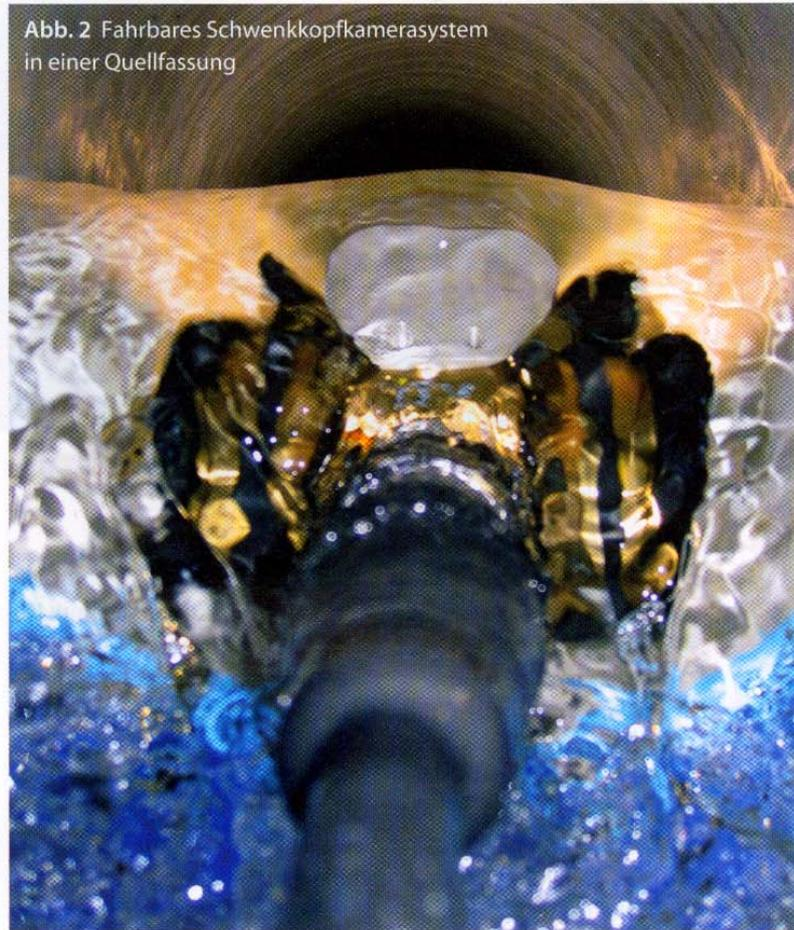
tungsanzeige des Kamerakopfes oder zielgerichtete Rissbreitenvermessung mittels Laserdioden. Für die Untersuchung von geotechnischen Erkundungsbohrungen und Horizontalfassungen bieten Schwenkkopfkameras die ideale technische Voraussetzung für aussagekräftige und umfassende Kamerainspektionen (Abb. 2).
